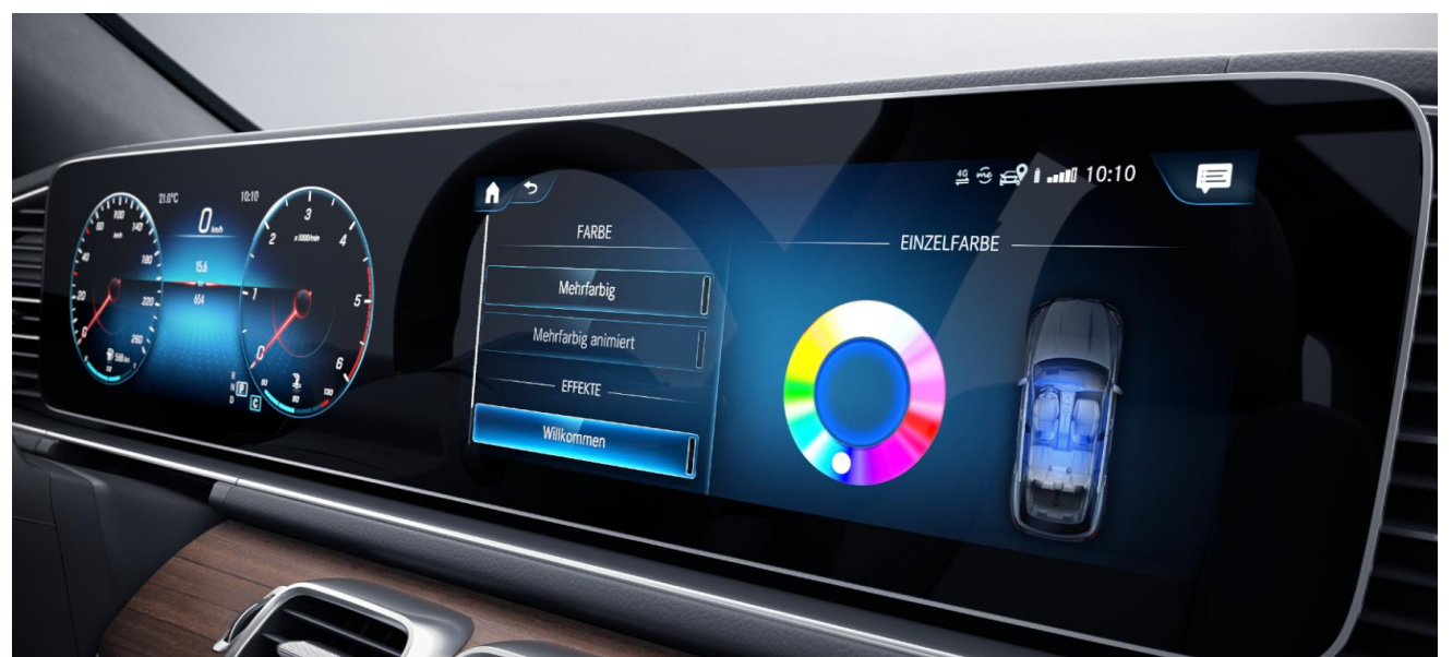
Cuadro de instrumentos digital de 10,3" y pantalla táctil de sistema multimedia MBUX de 12,3"
