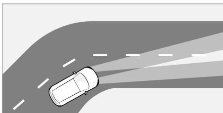
La iluminación en curva puede proporcionar un amplio efecto de iluminación de carril en la dirección de giro del vehículo, facilitando la visión de las condiciones de la carretera dentro del rango de giro.
