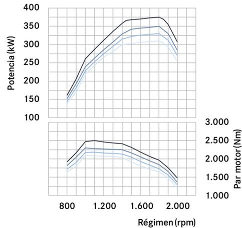
6 cilindros en línea 12,8 litros de cilindrada
