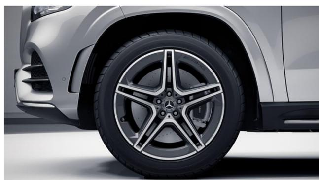
Llantas de aleación AMG 21" y 5 radios dobles diseño aerodinámico optimizado, color gris titanio y pulidas a alto brillo
