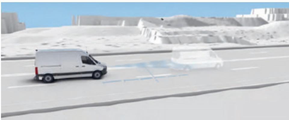
El **asistente activo de distancia DISTRONIC** puede mantener la separación ajustada por el conductor respecto al vehículo precedente y le facilita la conducción en tramos de autopista o en tráfico denso.
