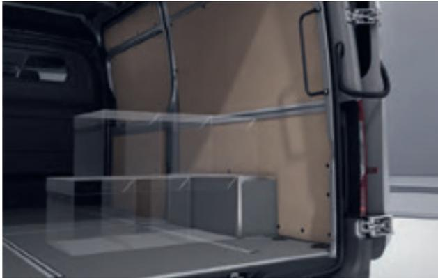
El revestimiento de madera en las cajas pasarruedas abre nuevas posibilidades de transporte en el espacio de carga y evita que se deteriore la chapa.
