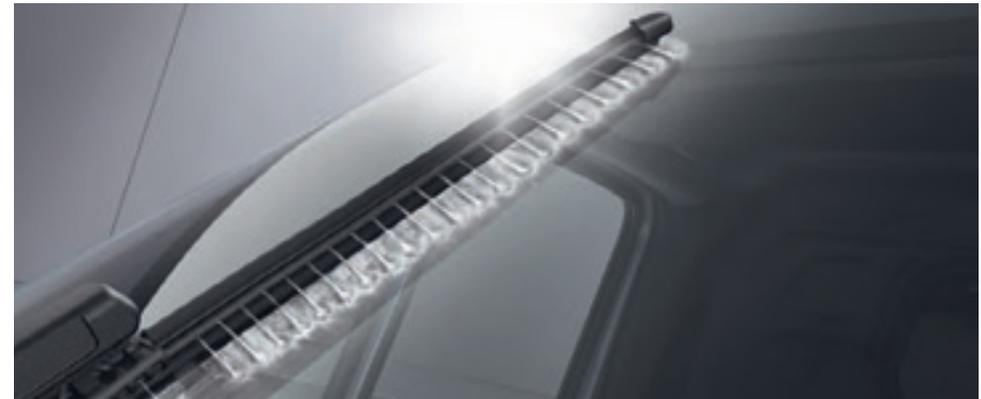
El sistema limpiaparabrisas **WET WIPER SYSTEM<sup>1</sup>** ofrece al conductor la mejor visibilidad posible, incluso durante el barrido del parabrisas.
