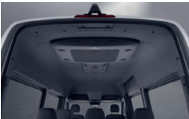
El aire acondicionado de alta potencia para el techo complementa el equipo delantero con una potencia frigorífica adicional de 11 kW y aumenta el confort en regiones o en días con temperaturas muy elevadas.
