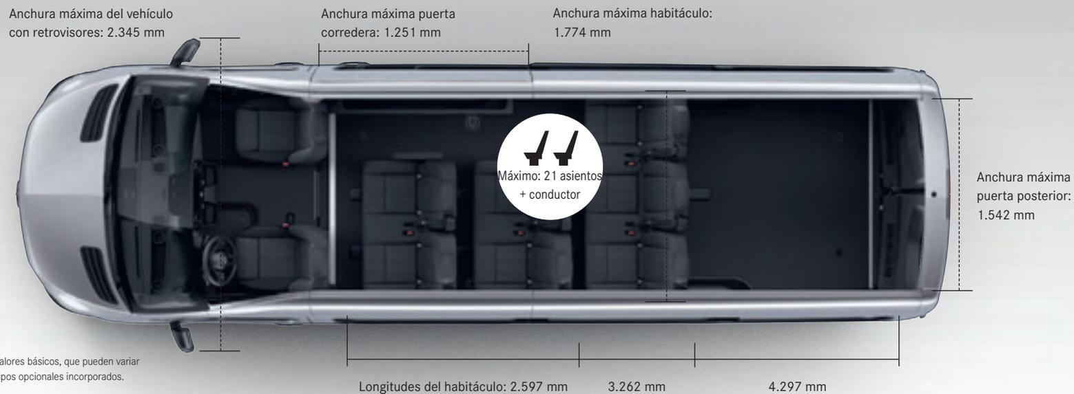
Las cotas y los pesos especificados del vehículo son valores básicos, que pueden variar en función del tipo de propulsión, el tonELAJE y los equipos opcionales incorporados.
