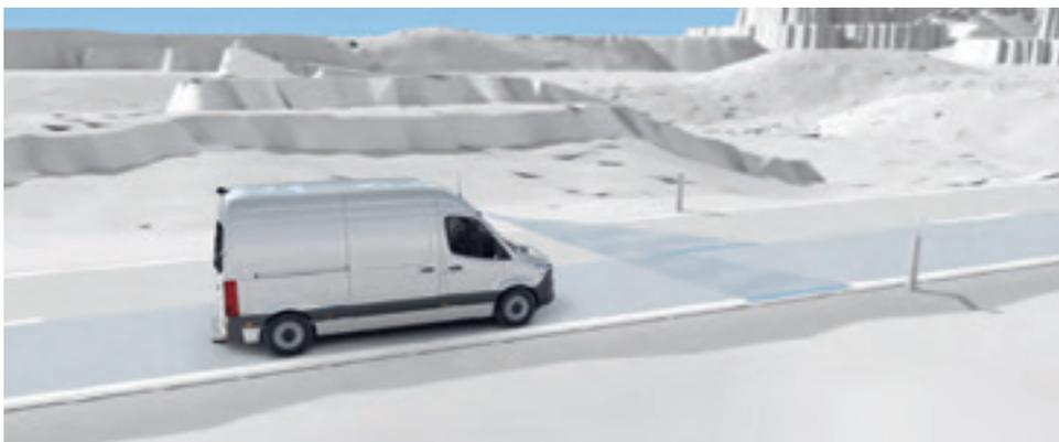
El **detector activo de cambio de carril** puede reconocer una salida involuntaria del propio carril, advertir al conductor y, en caso necesario, intervenir activamente en los frenos de un lado del vehículo para devolver el vehículo a su trayectoria.
