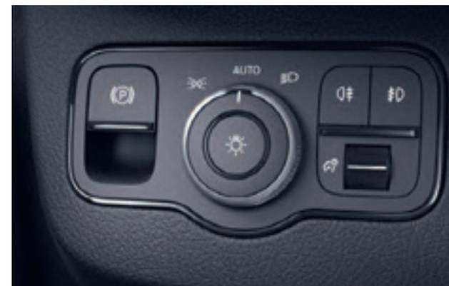
El freno de estacionamiento eléctrico se maneja cómoda y sencillamente por medio de una tecla. Al suprimirse la palanca del freno de mano, se facilita el paso del conductor hacia atrás.
