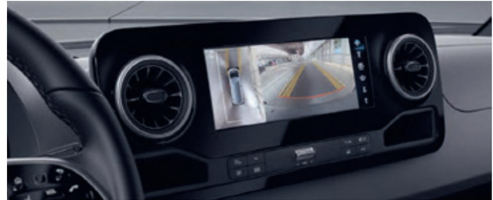
El **paquete de estacionamiento con cámara de 360°** ofrece amplia ayuda al estacionar y al maniobrar e incrementa de ese modo la seguridad y el confort.
