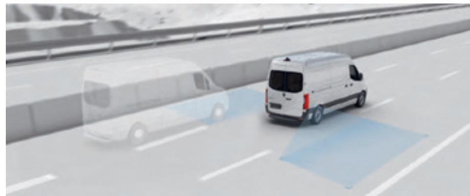
El **control de ángulo muerto con alerta por tráfico transversal por detrás** puede emitir señales de advertencia ópticas y acústicas y ayudar a evitar accidentes al cambiar de carril, al desaparcar hacia atrás y al bajarse del vehículo.
