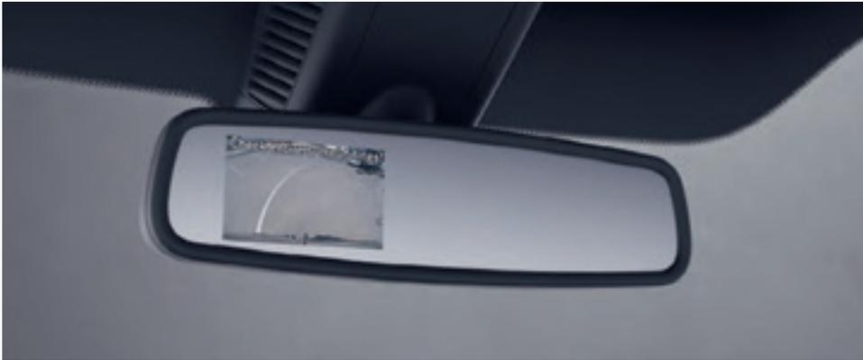
La **cámara de marcha atrás** con visualización de la imagen en el **retrovisor interior** mejora la visión de la zona situada inmediatamente detrás del vehículo y aumenta la seguridad al conducir hacia atrás.
