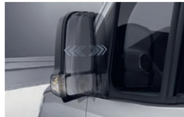
Los retrovisores exteriores con accionamiento eléctrico pueden replégarse para evitar daños al pasar por accesos estrechos o al aparcar.
