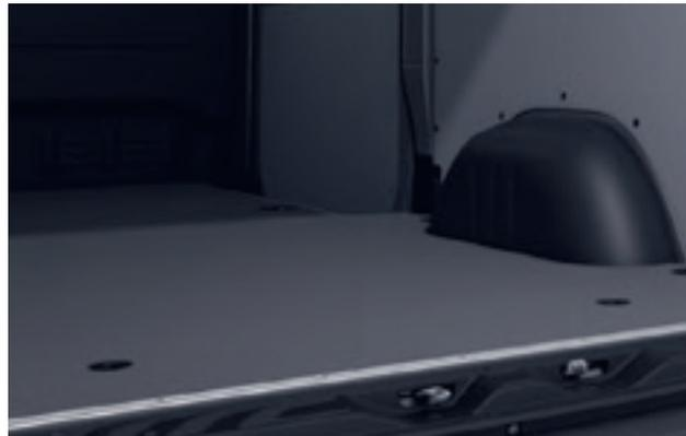
El piso de plástico de peso optimizado presenta una superficie lisa, lo que mejora la capacidad de carga del interior y facilita su limpieza. En comparación con el piso de madera, el peso disminuye en unos 18,5 kg. aproximadamente.
