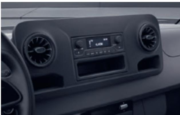
El sistema de audio Mercedes-Benz ofrece recepción de radio analógica y una interfaz Bluetooth® con función manos libres, así como una interfaz USB. Como equipo opcional es posible modificarlo y convertirlo en una radio digital.
