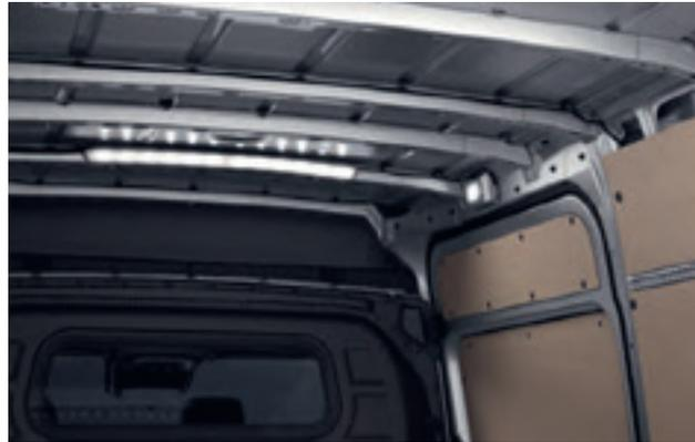
Las dos bandas luminosas LED bajo el techo iluminan el espacio de carga prácticamente sin sombras y mejoran de ese modo la orientación al cargar y descargar el vehículo.
