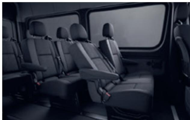
Si se desea aumentar el confort de los pasajeros puede optarse por diferentes asientos fáciles de montar y desmontar para las 3 filas, incluyendo respaldos individuales ajustables en inclinación en un margen de 20° y reposacabezas de confort.
