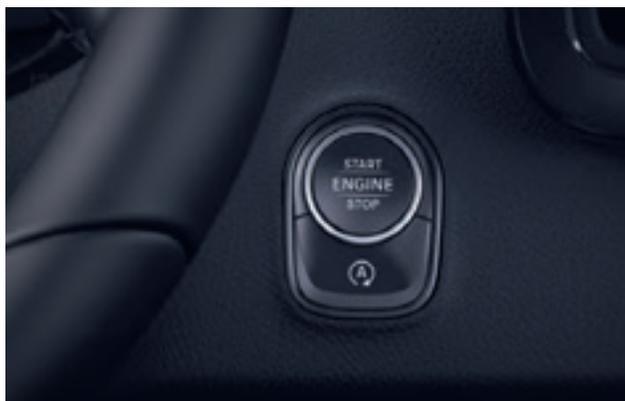
Basta con pulsar un botón para arrancar el motor. Si se adiciona el bloqueo electrónico de arranque KEYLESS-START es suficiente con pulsar la tecla de arranque y parada en la cerradura de encendido para arrancar el motor.
