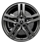
Llantas GLA 200 Pure: Llantas de aleación de 18" y 5 radios dobles, color gris tremolita 235/55 R18
